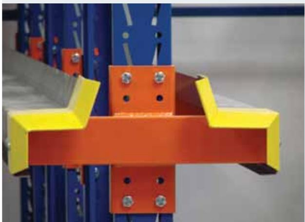
Ocelové konzoly jsou jednostranné nebo oboustranné a jsou přes závěs šroubované ke sloupům. Vjezdné regály dále obsahují hlavový nosník umístěný na horním konci sloupu k zajištění tuhosti sloupu. K zajištění stability vjezdného regálu slouží svislá a vodorovná zavětřovací táhla.
