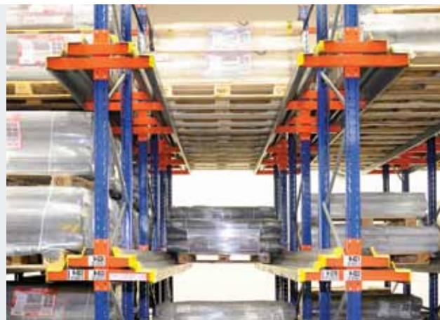
Vjezdné regály mohou být navrženy jako neprůjezdné nebo jako průjezdné (drive-through), tzn. že zboží je ukládáno z jedné strany a z druhé strany je odebíráno. Palety se ukládají na speciální šíny. Tyto šíny, tj. ukládací profily, jsou vyrobeny z ocelového ohýbaného pozinkovaného plechu.
